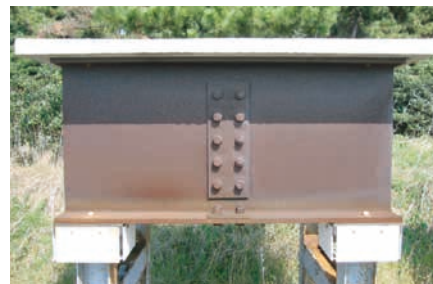
Type2 鋼の橋梁模擬構造体 岡山県倉敷市岸壁に2年暴露 (年間平均飛来塩分量: 0.3mdd)
